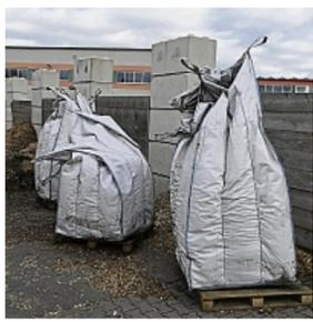
**Kohlenstoff-Pulver** in Big-Packs: Die Aktivkohle fällt als Reststoff bei der Pyrolyse an.
